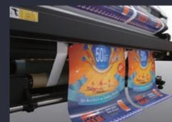
La découpe est possible en ligne à l'horizontale et à la verticale. Le système lit les marques de repérage dédiées et découpe automatiquement les feuilles, ce qui réduit considérablement la main-d'œuvre et optimise l'ensemble du post-traitement.
